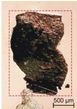
Querschnitt von Graphit E16 in transparentem Harz
