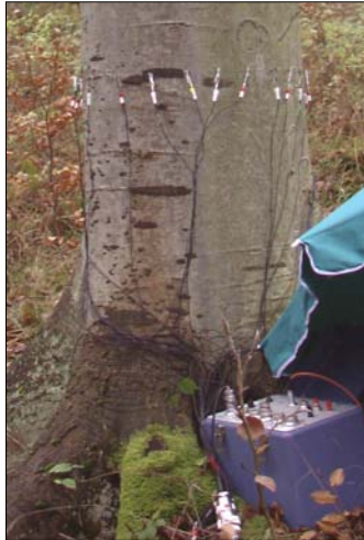
Abb. 4: Messung an Bäumen. Links: Messanordnung an einer Buche. Rechts: Widerstandstomogramm und Foto des Stammquerschnittes nach der Fällung (Fotos: U. Weihs).
