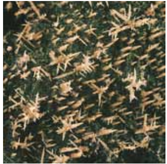
Schmelzkorund, synthetisch, Bildbreite ca. 2 cm
