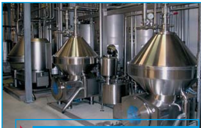
Blick in den Maschinenraum mit den Milchseparatoren
